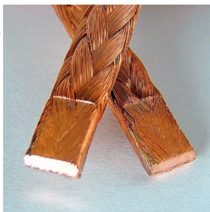
Zbrzyktowane końce linki o przekroju 14 mm 2
